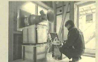
高気密・高断熱の住宅では重要な気密測定を行い、隙間があるかを測定器で検査していきます。検査をすることで施工精度の向上と品質を確保しています。
